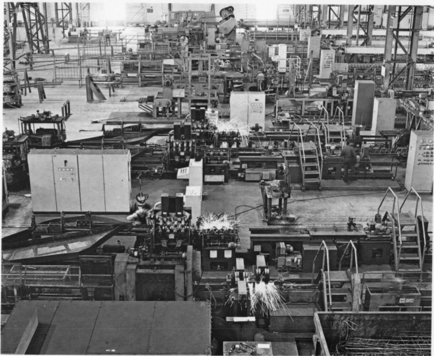
I reparti di elettrosaldatura tralicci e (nella pagina successiva) di elettrosaldatura reti della Ferriere Nord S.p.A. Le armature elettrosaldate Pittini realizzate con acciai qualificati, sono già impiegate in diversi Paesi ai massimi tassi di lavoro, anticipando così le prescrizioni delle future specifiche europee.
