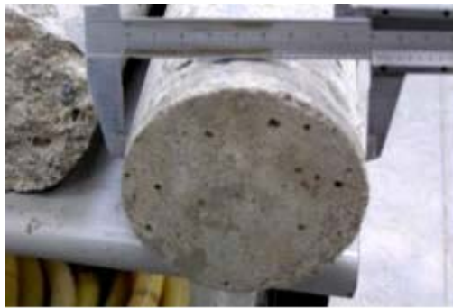
Figura 1. Verifica tolleranze carota
