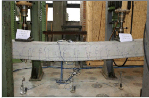
Figura 18. Trave con soletta piena al collasso
