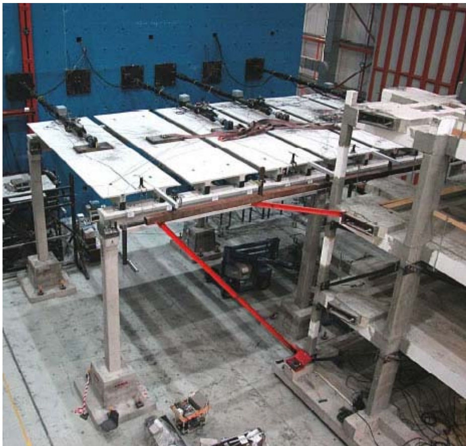
Figura 4. Vista dell'impianto di prova per il prototipo con elementi di copertura disposti parallelamente all'azione sismica.
