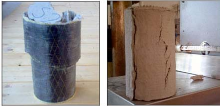
Figura 2. Rottura dei provini cilindrici
