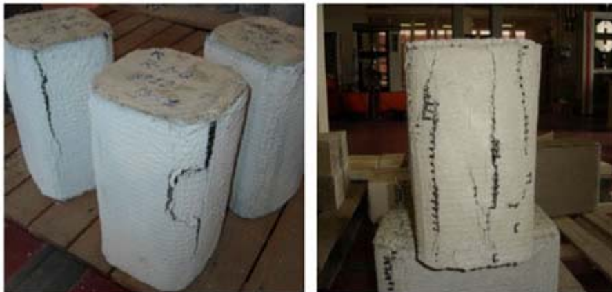
Figura 7. Rottura dei provini prismatici
