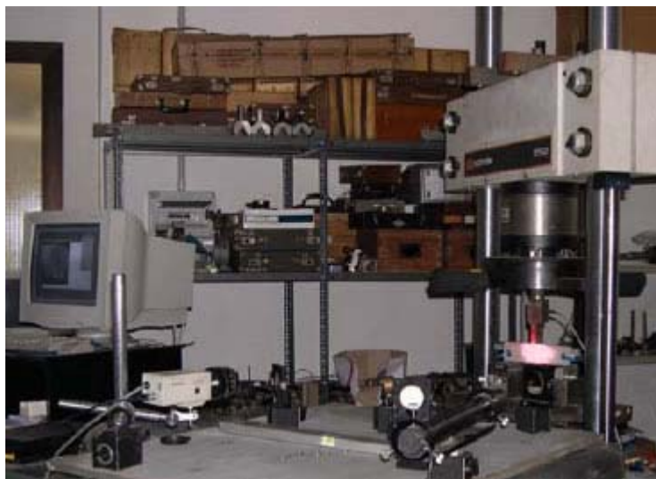
Figura 1. Setup per prove di flessione
