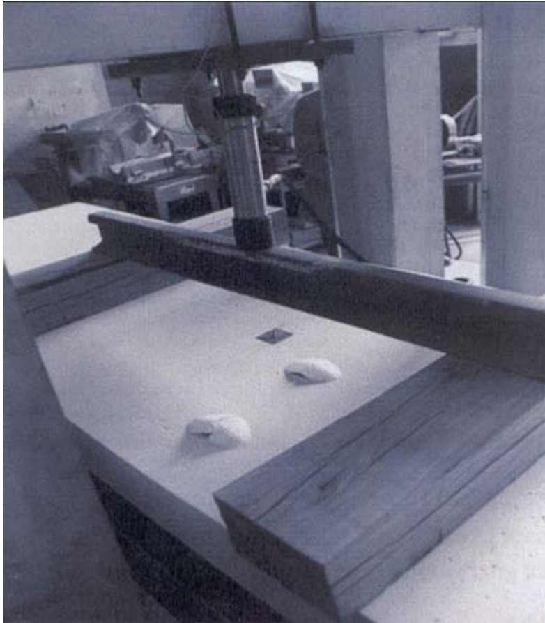
Figura 2. Prova su solaio senza cappa [9]
