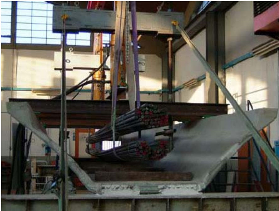
Figura 4. Sezione trasversale del tegolo durante la prova di carico, con applicazione dei carichi sulle ali tramite martinetti e sulla soletta tramite fasci di barre.
